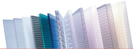
Il **Makrolon® multi UV 5M/25-20** è una lastra alveolare di 25 mm di spessore in polycarbonato con sezione ad M che ne migliora la rigidità. Le caratteristiche della lastra permettono di combinare una buona capacità di portata con un buon isolamento termico, trasmissione di luce ed un'ottima resistenza agli agenti atmosferici. La lastra è, inoltre, leggera, resistente agli urti e facile da montare.
